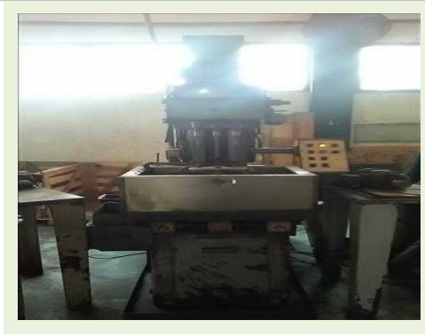
FURADEIRA DE COLUNA MARCA BREVET- BURKHARDT MODELO HB 130, PEDIDO 420.206.60 | Item: 108 |
