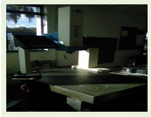
MÁQUINA TRIDIMENSIONAL CNC MARCA DEA MISTRAL MOD. 070705 NS. RM070705100 | Item: 75 |
