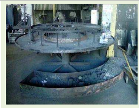
RODA GIRATÓRIA PARA VERIFICAÇÃO DE VAZAMENTO DE DISCO DIAM. 3,60 M (DESATIVADO) | Item: 116 |
