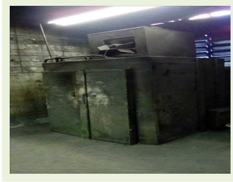
ESTUFA A GÁS DIM. EXTERNA 1.800X1.650X2.000 MM 220V | Item: 122 |
