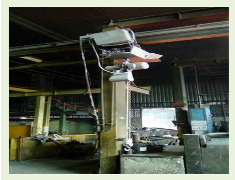
TALHA ELÉTRICA DE CORRENTE MARCA SAMM CAP. 1 TON. ELEVÇÃO APROXIMADA 4 M | Item: 93 |
