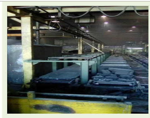
MESA DE ROLETES PARA RETORNO PALLET LINHA 4 MARCA IMF DIM. 700X22.100 MM | Item: 70 |
