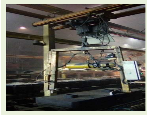
MANIPULADOR MARCA IMF MOD. ML-1000 ABERTURA 500 A 1000 COM SISTEMA HIDRÁULICO E TALHA MARCA DEMAG MOD. DC-COM 1 TON |
