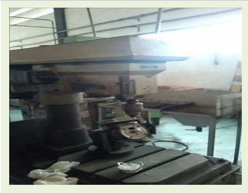
FURADEIRA DE COLUNA MARCA DAUERT MOD. DF 12, Nº 8023, CAP. FURAÇÃO 12 MM EM AÇO | Item: 17 |
