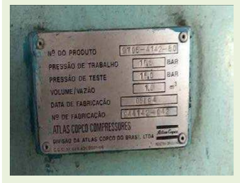
VASO DE PRESSÃO MARCA ATLAS COPCO, CAP. 1 M 3 , N. PRODUTO 9705-4142-80, NR. 944142-042 | Item: 106 |
