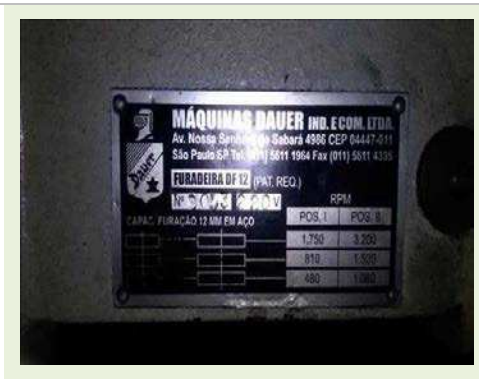
FURADEIRA DE COLUNA MARCA DAUER MOD. DF 12, Nº 9053, CAP. FURAÇÃO 12 MM EM AÇO | Item: 127 |
