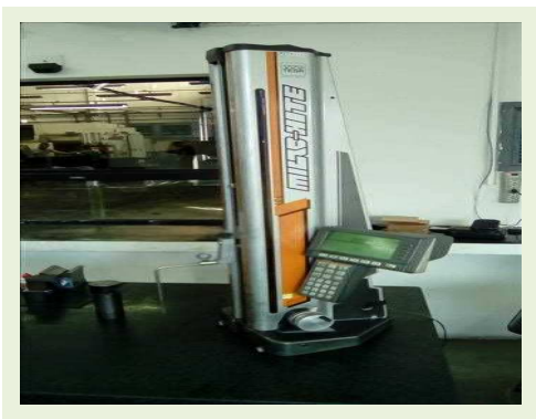
MEDIDOR DE ALTURA DIGITAL MARCA TESA MOD. MICRO-HITE 600 | Item:
