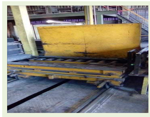
CARRINHO SIMPLES PARA LINHA DE MOLDAGEM E DESMOLDAGEM COM UNIDADE HIDRÁULICA MARCA IMF | Item: 27 |
