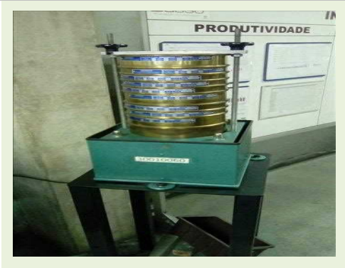
AGITADOR DE PENEIRAS ELETROMAGNÉTICO MARCA SOLOTEST REF. 1202230, 220V NS. 4881 COM JOGO DE 11 PENEIRAS | Item: 12 |
