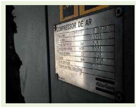
COMPRESSOR MARCA ATLAS COPCO MODELO GA 110-100AP, Nº SÉRIE 316360, ANO FABRICAÇÃO 2005, MOTOR POT. 150 CV, PRESSÃO FINAL MAX. 7,4 BAR, DESCARGA LIVRE EFETIVA 1271 M3/H, 1780 RPM, 220 V | Item: 96 |
