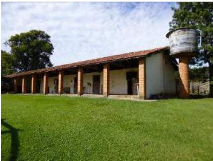
Trata-se de uma edificação térrea, onde funcionavam baias para criação de cavalos, com 248,00 m<sup>2</sup> de área construída, do tipo Galpão de Padrão Simples (-), que denota idade de 30 (trinta) anos e encontra-se em estado de conservação necessitando reparos simples “e”.
