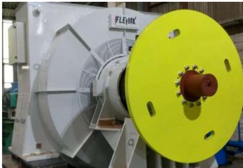
**PCH ARS (02 x 4.000kVA-180RPM-6,9kV)**
